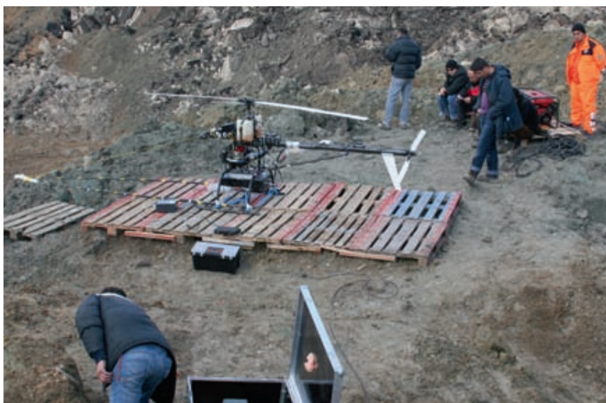
Bild 5 Der Scout B1-100 UAV-Helikopter im Einsatz für das automatische, magnetische Scannen nach dem Grubenunglück.
