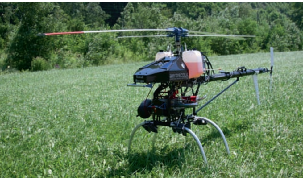
Bild 2 Der Scout B1-100 UAV-Helikopter während eines Testflugs in der Schweiz mit einem Bleigewicht von rund 15 Kilo.
